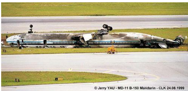
Rys. 39. Katastrofa MD-11 w Hong Kongu w dniu 22.08.1999. Widok wraku od prawej strony ze śladem po urwanym skrzydle [64].
