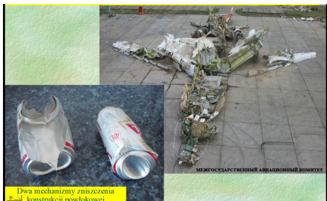
Rys. 48. postać zniszczenia Tu-154 w katastrofie smoleńskiej.
