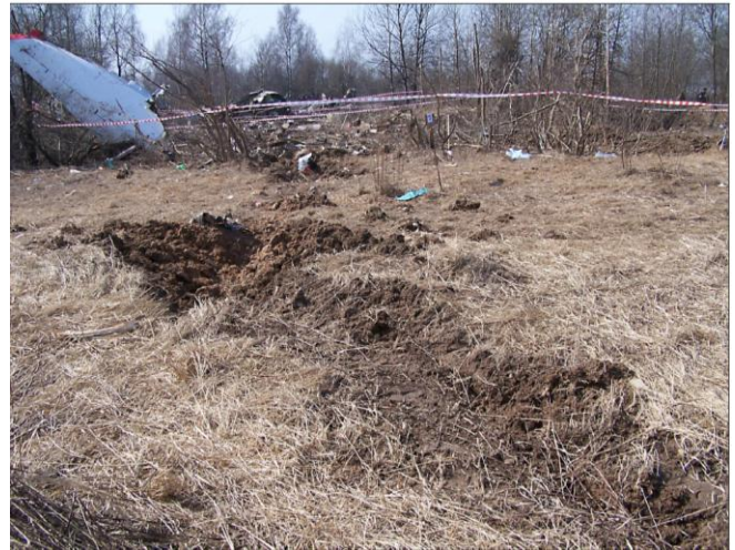
Rys. 43. Bruzda w ziemi (rysunek 30 z raportu MAK), która według MAK jest dowodem, że samolot uderzył w ziemię górnym statecznikiem i oderwał mu się ogon.
