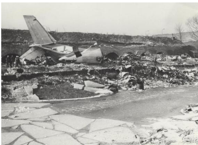
Rys. 16. Miejsce katastrofy samolotu Il-62 „Kopernik”. Samolot przebił lód i uderzył w zbocze fosy pod kątem zbliżonym do 90 stopni [31].
