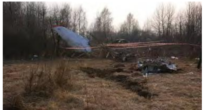
Rys. 44. Ta sama bruzda przedstawiona na rysunku 12 w raporcie Komisji Millera z podpisem „Rys. 12. Ślad na ziemi spowodowany lewym sterem kierunku”.
