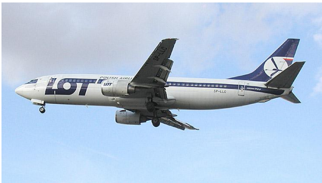
Rys. 5. Przykład oznaczenia polskiego samolotu cywilnego – SP-LLC. SP to znak przynależności do Polski, LLC to znak rejestracyjny, w którym pierwsza litera L oznacza właściciela PLL LOT, druga litera L oznaczająca Boeinga 737-400, a trzecia litera C oznacza, że jest to trzeci Boeing tego typu Lotu. Na ogonie symbol Lotu – stylizowany żuraw.
