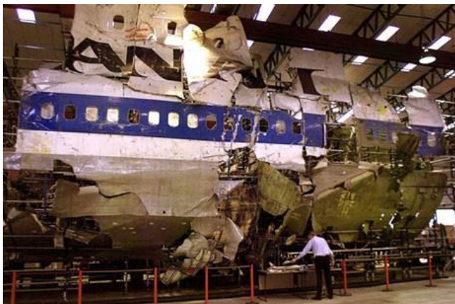
Rys. 31. W hangarze na specjalnie wykonanym stelażu mocuje się kolejne szczątki odtwarzając całą konstrukcję samolotu. [55].
