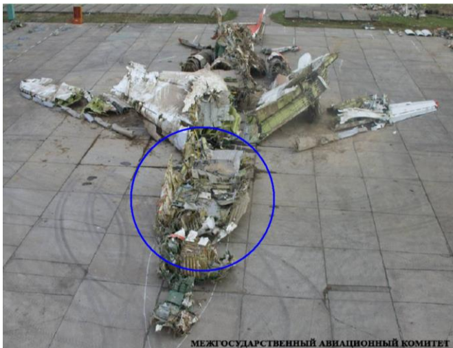
Rys. 1. Kadłub wraku, który według MAK powstał w wyniku zgniatania wynikającego z działania sił zewnętrznych - uderzenia w ziemię. Świadczenie fałszywości hipotezy MAK/Millera.
