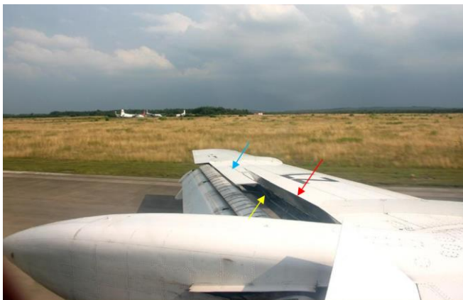
Rys. 9. Widoczny sposób mocowania spoilerów (strzałka niebieska) i interceptorów (strzałka czerwona) do tyłu dźwigara nr 3, zamykającego od tyłu tylny keson (strzałka żółta). Takie rozwiązanie techniczne tłumaczy brak znaczących błędnych wychyleń interceptorów i spoilerów w czasie niszczenia przedniego kesonu, a także możliwe duże błędne wychylenia wybranych elementów tylnej mechanizacji płata, gdy niszczeniu ulega sam tył struktury skrzydła, w szczególności tylny dźwigar. Fot. Internet.
