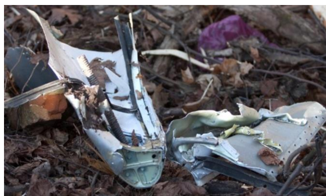
Rys. 5. Fragmenty slotu, zniszczonego prawdopodobnie w Fazie 2, znalezione przed jezdnią ul. Gubienki. Fot. Internet
