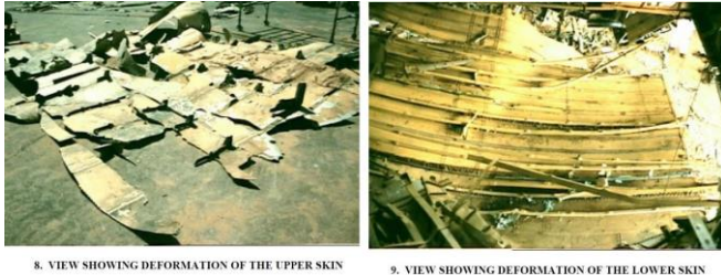
Rys. 6. Różnice we fragmentacji poszycia: górnego (rozerwanie na niewielkie części - po lewej) i dolnego (częściowe naderwanie i wybrzuszenie - po prawej) w zbiorniku paliwa B747 wskutek eksperymentalnej eksplozji FAE w Bruntingthorpe [31].
