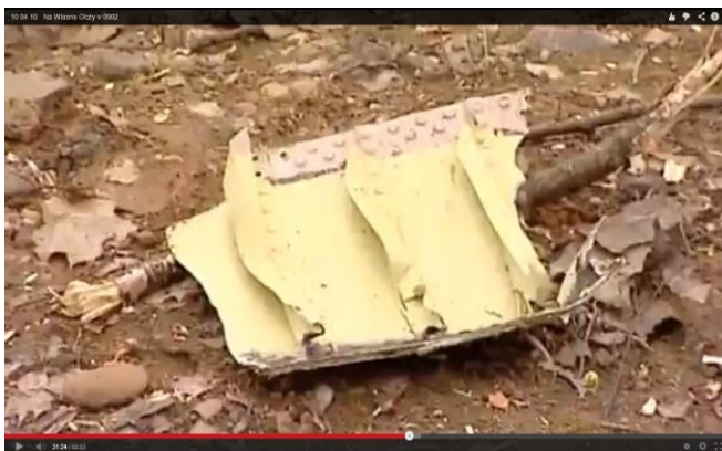
Rys. 10. Fragment środkowego dźwigara (najprawdopodobniej nr 2, być może zniszczonego w Fazie 3), znaleziony pomiędzy jezdnią ul. Gubienki, a TAWS#38 [38].
