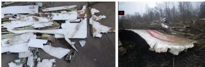
Rys. 7. Różnice we fragmentacji poszycia: górnego (rozerwanie na niewielkie części - po lewej) i dolnego 35 (wyrwanie i wybrzuszenie - po prawej) w lewym skrzydle Tu-154M „101” w Smoleńsku. Dolny panel sfotografowano na wrakowisku. Charakterystyczny jest brak śladów wgłębień i miażdżenia materiału oraz zadrapań lakieru po uderzeniach w drzewa na poszyciu dolnym i górnym kesonu w kierunku lotu, a także dominujący kształt szczątków - pasy poszycia górnego równoległe do podłużnic. Fot. via Krzysztof Mądel (zdjęcie po lewej), Internet (zdjęcie po prawej).
